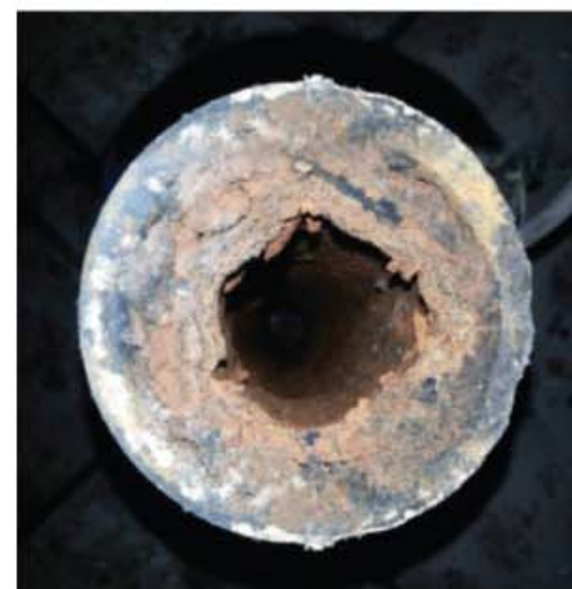
รูปตะกอน และสนิมอุดตันภายในท่อเหล็ก
