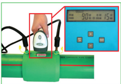
6. นำหัวอ่านบาร์โค้ดอยู่ที่บาร์โค้ด เวลาในการให้ความร้อน (Fusion) และเวลาในการเย็นตัว (Cooling) จะปรากฏที่จอแสดงพล็อตอัตโนมัติ จากนั้นกดปุ่ม START เริ่มทำงาน
