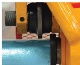
สอดท่อให้หน้าตัดท่อชนแนบกับหัวกรูฟ
