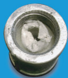
ข้อต่อเสียหาย เพราะปลายท่อเหล็กบานออก
